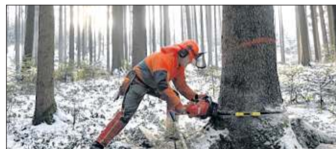
Keile verhindern ein Steckenbleiben der Motorsäge.
